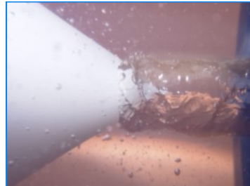
Implosion de l'eau à la sortie de la spirale et création du vortex
